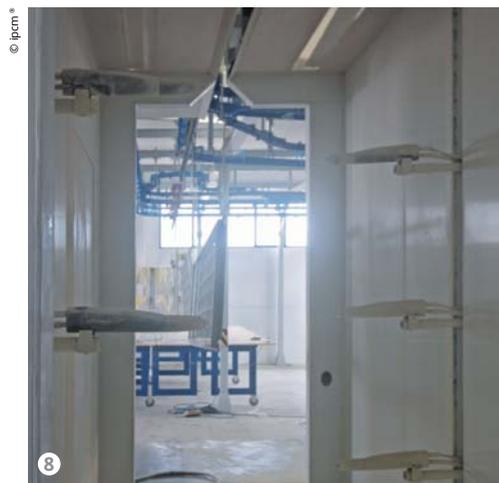
Figura 8: Interno della cabina per l'applicazione del primer.
