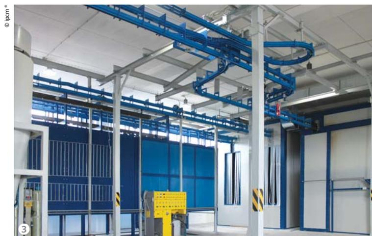
Figura 3: Dettaglio del trasportatore CM Automazione nell'area di pretrattamento.
