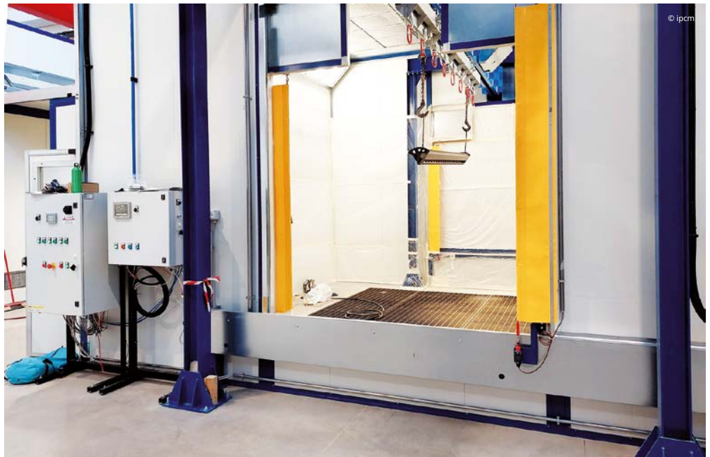
La cabina di applicazione del primer con uno dei quattro dispositivi Wagner Intellimix Touch 2k.
