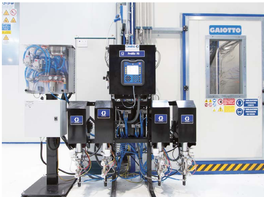
La macchina miscelatrice PDK1 di Graco con 4 pompe separate per ciascun colore, installata da Comaind di San Giovanni Lupatoto, Verona.
