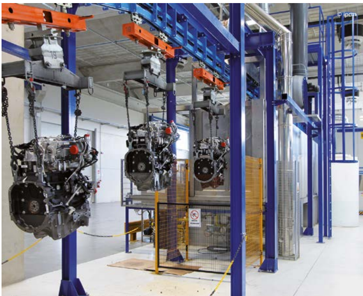
Il tunnel di pretrattamento.
