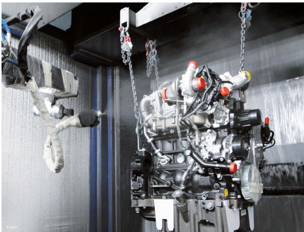
Dettaglio della spruzzatura automatica con robot Gaiotto GA2000 e pistola Graco AirPro.
