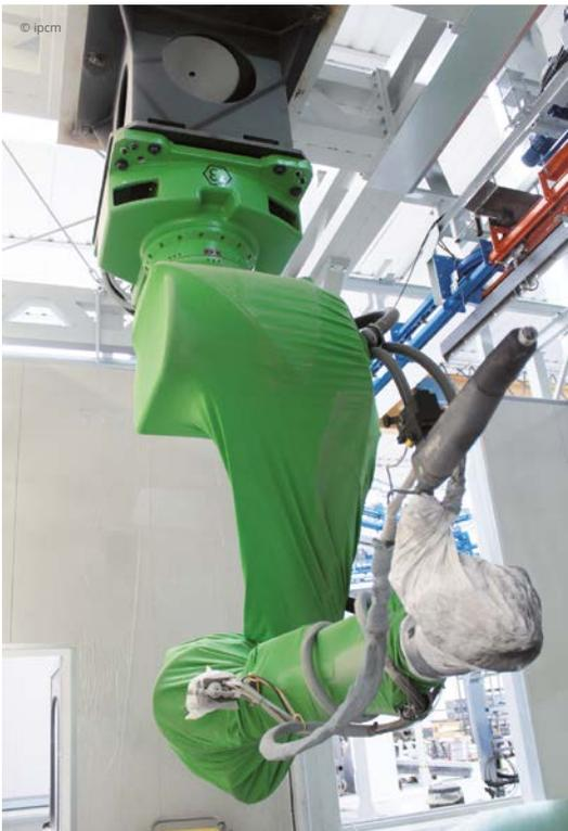
**Il robot antropomorfo a 6 assi della serie 6100 di CMA Robotics montato a soffitto.**
