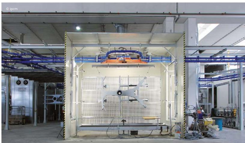
verifichiamo i parametri ambientali e lo spessore umido, mentre post-applicazione controlliamo lo spessore secco e l'adesione, ed eseguiamo il Cross Cut Test, il Pull Off Test e le prove di porosità. Nel nostro team è presente anche un tecnico con Certificazione NACE che garantisce l'altissima qualità delle prove anticorrosive erogate".
