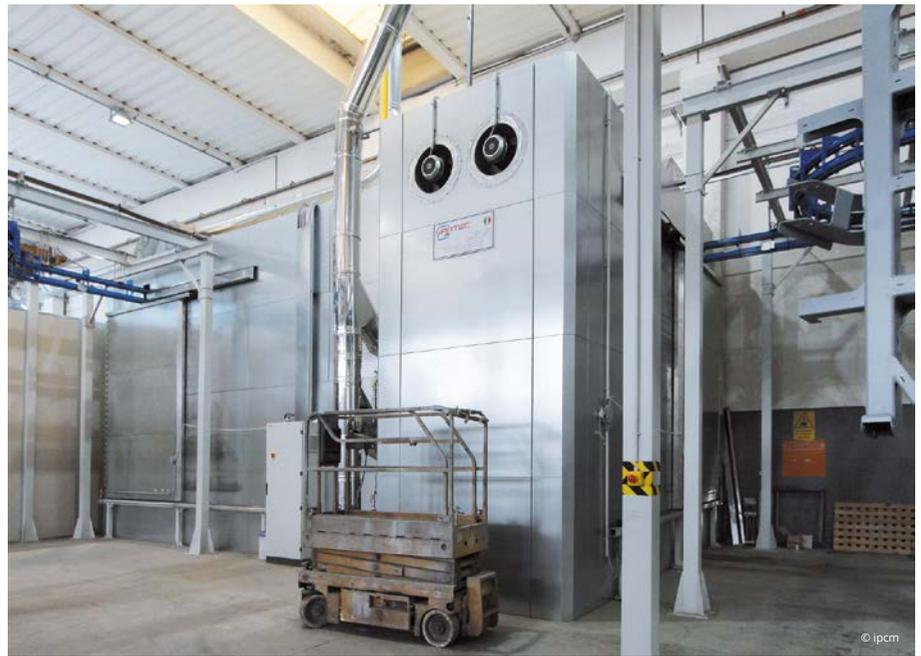
Il forno di polimerizzazione installato da Sartec.
